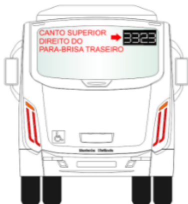
Painel traseiro de LED branco: mínimo de 16 linhas x 48 colunas
